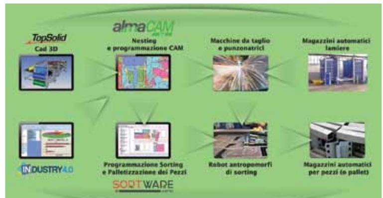
SORTware® è l'intelligenza che trasforma un robot antropomorfo o un portale cartesiano in un sistema automatico di carico lamiera e sorting di pezzi tagliati, interconnesso con ERP/CAD/CAM e integrato con macchine da taglio e con magazzini di lamiera e pezzi.
