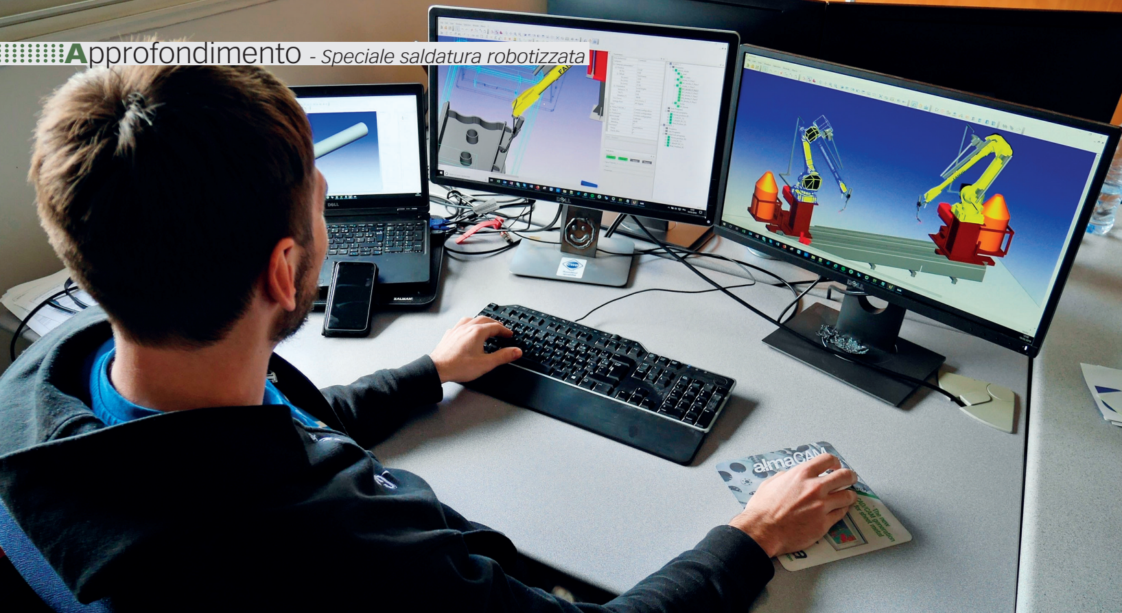
almaCAM Weld fornisce all'utente un'esperienza interattiva e automatica, molto più veloce della programmazione per autoapprendimento.
